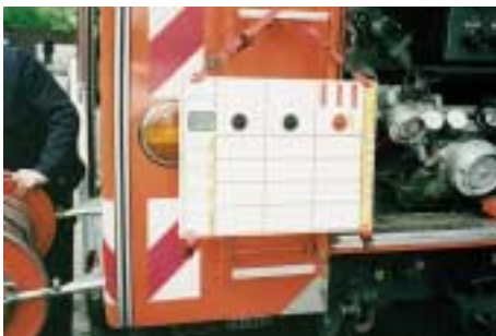
Abb. 2.1.1/3: Hier ist eine ältere Tafel provisorisch an der Aufstiegleiter befestigt. (Foto: Cimolino)
