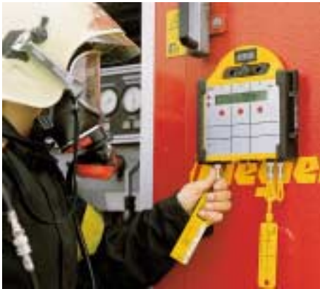
Abb. 2.1.1/2: Atemschutzüberwachungstafel mit spezieller Befestigung neben GR (Foto: Dräger safety)
