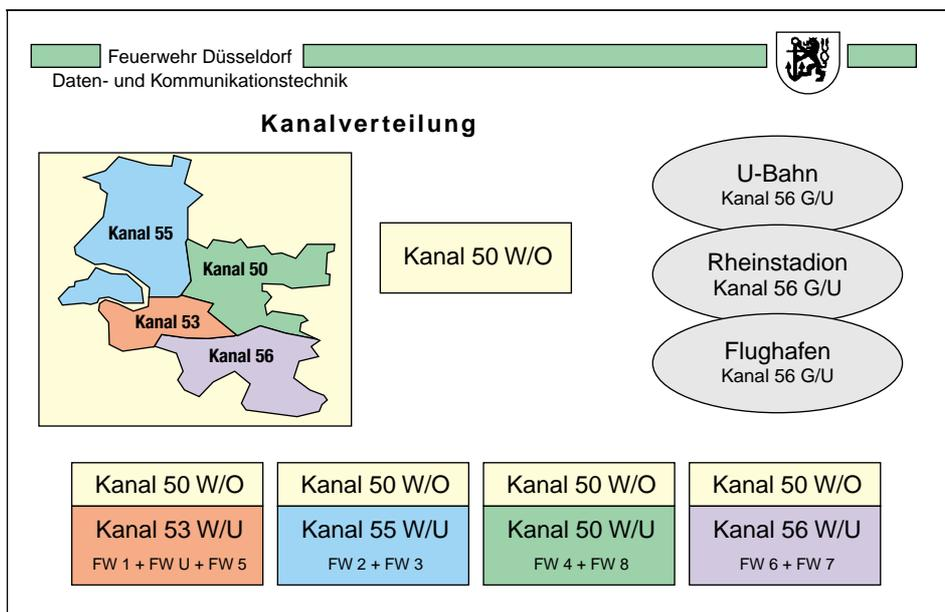
Abb. 4.4.4/1: Kanalverteilung in Düsseldorf in der Kanaltrennung nach Version 4, nicht mehr in Gebrauch (Grafik: Schneider)
