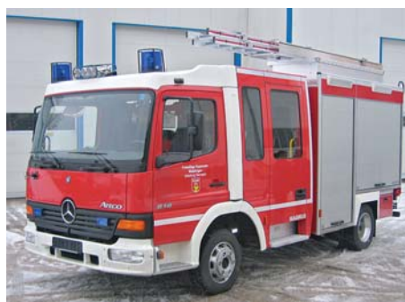
Abb. 4.1.1.4/6: Mannschaftskabinenverlängerung auf DC Atego (Foto: Iveco Magirus Brandschutztechnik GmbH)
