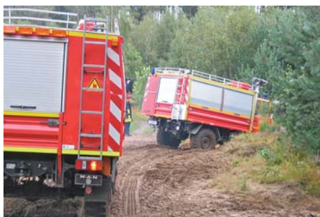
Abb. 4.1.4.2/2: Singlebereifte RW 1 (der ehemaligen LZ-R des KatS) auf VW-MAN bzw. Unimog U 1300 mit spurgleichen Vorder- und Hinterachsen (Foto: Hilger, Düsseldorf)
