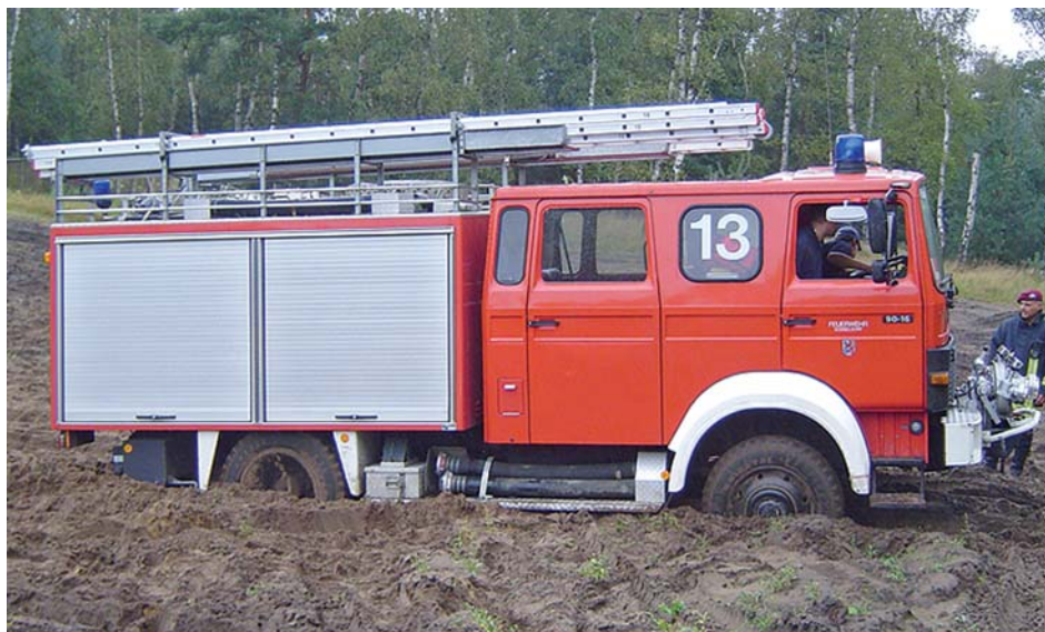
Abb. 4.1.4.2/3: Am schlechtesten schneiden in schwerem Gelände Fahrzeuge mit zwillingsbereifter Hinterachse ab. Bei (Tank-)Löschfahrzeugen mit Gruppenkabine kommt i. d. R. noch dazu, dass die Hinterachse im Verhältnis zur Vorderachse viel stärker belastet ist, so dass die Vorderachse bei leerer Kabine weniger zur Traktion beitragen kann. Teilweise hilft es, die Kabine zu besetzen und/oder Löschwasser abzulassen (oder Ausrüstung auszuladen), um die Hinterachse zu entlasten. (Foto: FF Düsseldorf LG Kalkum)
