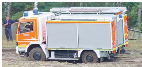
Abb. 4.1.4.2/1: Singlebereiftes TLF 16/24-Tr (Ziegler) mit zweiteiligem Aufbau auf MB Atego 917 AF der FF Düsseldorf. Die HA ist durch den zweiteiligen Aufbau schmaler als die VA. In schwerem Boden ist die Gefahr des Festfahrens größer als mit spurgleichen Fahrzeugen. (Foto: Spikowski, Düsseldorf)
