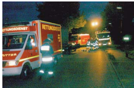
Abb. 4.19.3/5: Die Wirkung der Umrisskennzeichnung sowie der reflektierenden Beschriftung ist nachts und auch bei Dämmerung jeder anderen Form der Oberflächenausführung überlegen. Vergleichen Sie bei dem nächtlichen Einsatzbild die Wirkung der Beklebung (Koffer-RTW) bzw. Lackierung (Kasten-RTW 1 sowie LF 24) und diese jeweils mit den Reflex-Beklebung des Umrisses bzw. der Beschriftung. (Foto: Bildstelle der Feuerwehr Düsseldorf)
