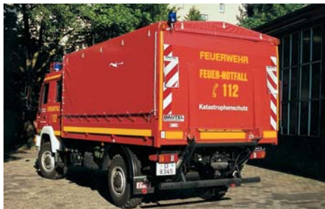
Abb. 4.19.3/3: Sicherheitskennzeichnung und Umrissbeklebung an einem LKW Dekon-P der Feuerwehr Düsseldorf. An der Ladebordwand befinden sich links und rechts zusätzlich nur oben befestigte reflektierende Sicherheitskennzeichnungen auf Planenstücken, die beim Abklappen der Ladebordwand weiter sichtbar bleiben. (Foto: Cimolino)
