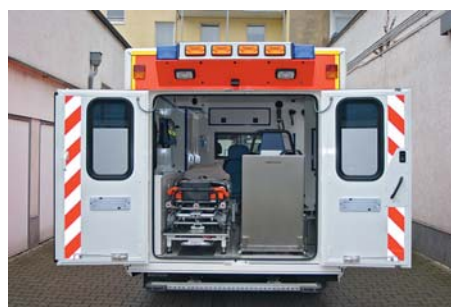
Abb. 4.19.3/2: Sicherheitskennzeichnung an den in 180° feststellbaren Türen eines KTW (KFB auf VW T 5-Triebkopf) der Feuerwehr Düsseldorf (Foto: Truckenmüller, Düsseldorf)
