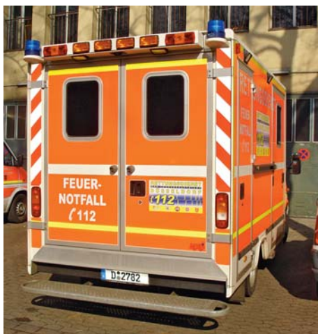
Abb. 4.19.3/4: Sicherheitskennzeichnung, Umrissbeklebung sowie Heckwarnanlage an einem RTW (Typ C nach DIN EN 1846) der Feuerwehr Düsseldorf, Aufbau WAS auf einem MB Sprinter 413 CDI Sprintshift (Foto: Cimolino)
