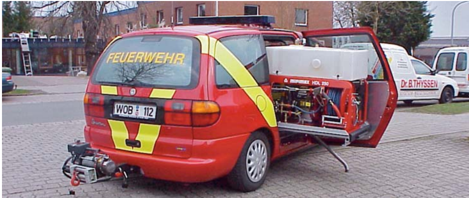
Abb. 4.9.2/2: VW Sharan mit Höchstdrucklöschanlage HDL 250 1 (Fa. Minimax) der BF Wolfsburg als Fahrzeug auch für Brände in Tiefgaragen. Beachten Sie die Belastung der Hinterachse! (Foto: de Vries)
