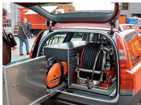
Abb. 4.9.2/5a) und b): VRW der BF Hamburg für den Einsatz im Elbtunnel mit IFEX-Löschanlage im Heck (Fotos: de Vries)
