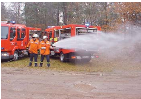
Abb. 4.9.2/3: Ziegler TSF-W auf RENAULT mit HD-Anlage, achten Sie auf die geringe Wurfweite des Wasserstrahls! (Foto: de Vries)
