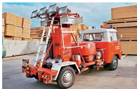
Abb. 2.2.3.4/7a): LiMaF auf Hanomag-Henschel F 25 mit Lichtmast bzw. Stromerzeuger von Polyma der FF Frankenberg (Eder). Einige Aufbauten dieser Landesbeschaffung wurden in den letzten Jahren auf neuere Fahrgestelle umgesetzt (vgl. Abb. 2.2.3.4/7b)). (Foto: Tampier, Dortmund)
