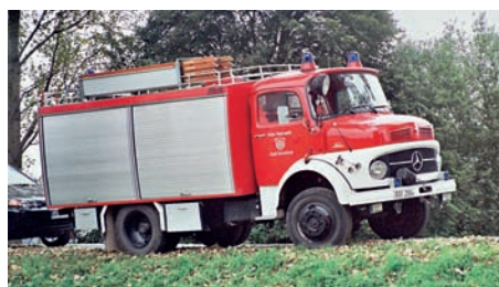
Abb. 2.2.3.4/8: RW 1 auf MB LAF 911 mit Metz-Aufbau der FF Gernheim (Foto: Tampier, Dortmund)
