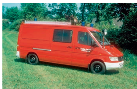
Abb. 2.2.4.3/2: TSF ohne getrennten Aufbau der FF Christinental auf MP Sprinter 312D, Aufbau von Ziegler (Foto: Klingenhöller, Wrohm)
