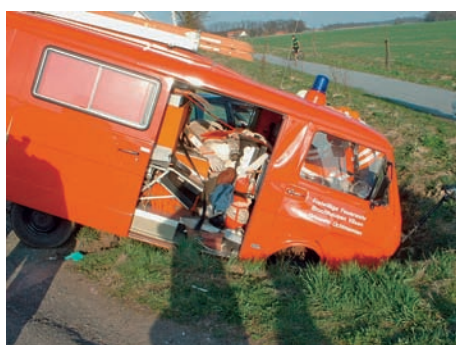
Abb. 2.2.4.3/3: Verunfalltes TSF; TS hat sich gelöst, ebenso ein Großteil der Ausrüstung. (Foto: Voß, Ortsfeuerwehr Bruchhausen-Vilsen)
