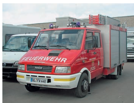
Abb. 2.2.4.3/4: TSF-W-Straße der ersten Generation mit 5,5 t zGM, Iveco Daily mit Schwäble-Aufbau (Foto: Zawadke)
