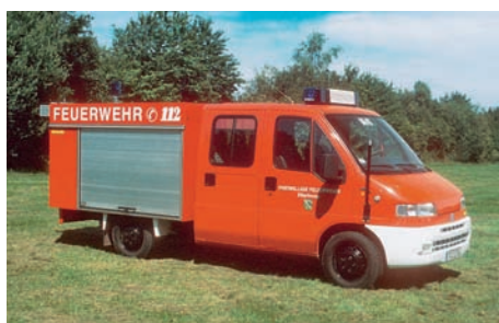
Abb. 2.2.4.3/1: TSF mit getrenntem Aufbau der FF Ellerhoop auf Fiat Ducato, Aufbau Schmitz (Foto: Klingenhöller, Wrohm)
