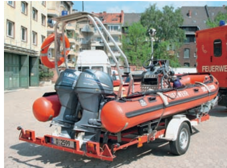
Abb. 3.1/2: Bootsanhänger für ein RTB 2, hier hinter einem GW-W der Feuerwehr Düsseldorf, mit Wechselkupplung, hier für LKW-Anhängerkupplung (Foto: Truckenmüller, Düsseldorf)
