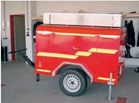
Abb. 3.1/1: Tragkraftspritzenanhänger (TSA), hier ein älteres Modell der FF Thalfingen, werden nicht nur zur Ausbildung (oft auch der Jugendfeuerwehr) sondern auch zum stationären Einsatz bei längeren Lagen (z.B. Hochwasser) genutzt. (Foto: Zawadke)
