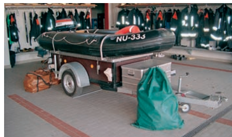
Abb. 3.1/4: Ungebremster 600-kg-Anhänger mit langer Deichsel und geschlossenem Kasten für das Zubehör zum Transport des RTB 1 mit Außenborder und der Ausrüstung für die Eis- und Wasserrettung der Feuerwehr Thalfingen/Elchingen (Foto: Zawadke)
