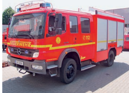
Abb. 3.5.3/4: LF 16-TS (KatS) bzw. LF-KS der Feuerwehr Hamburg, Fahrzeuge dieses Typs wurden ab 2005 in mehr als 50 Stück (Ziegler auf MB Atego) ausgeliefert. Das Fahrzeug verfügt im Gegensatz zum Prototyp (vgl. Abb. 2.2.4.5/6) über einen Löschwasserbehälter mit 1.600 l – und kann daher im Heck keine Schlauchschieber mehr aufnehmen. Die B-Schläuche werden daher wieder gerollt mitgeführt. (Foto: Lahmann, Hamburg)
