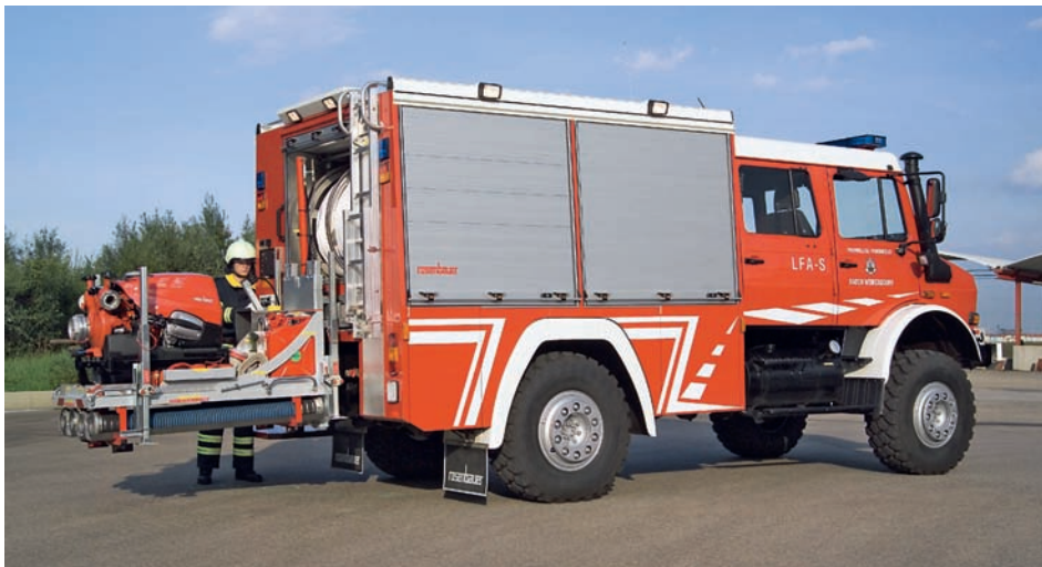
Abb. 3.5.3/5: Österreichisches LFA-S der FF Weikersdorf/A mit Saugstellenblock und Haspel im Heck zum Verlegen der Druckschläuche während der Fahrt. (Foto: Rosenbauer)
