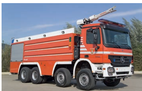
Abb. 3.6.7/4: GTLF 14000 der BF Ljubljana/Slovenien mit 13.000 l Wasser, 1.000 l Schaum, auf einem MB Actros 4150 K 8x4 mit Aufbau Rosenbauer (Foto: Rosenbauer)
