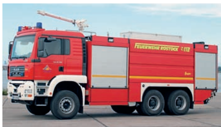
Abb. 3.6.7/2: GTLF 30/80/8 der Feuerwehr Rostock, Aufbau Ziegler auf MAN 26.350 (Foto: Klingelhöller, Wrohm)
