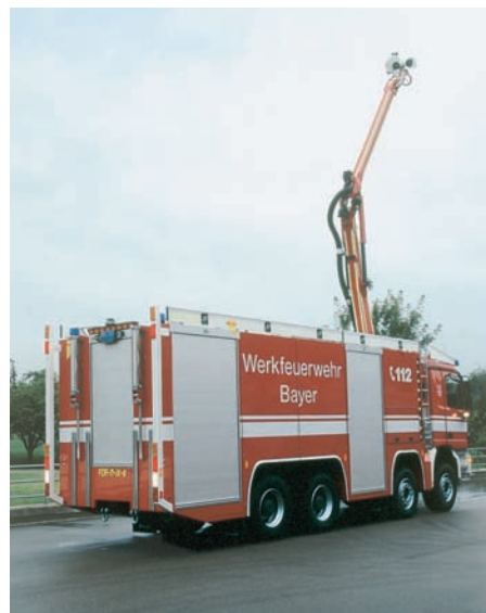
Abb. 3.6.7/3: Mit 12.000 l Wasser, 5.500 l Schaum, FP 10-10000, Druckschaumzumischtechnik (Schaumpumpe über 600 l/min), einem Löscharm mit 11,5 m und Werferleistung von ca. 1.000–6.000 l/min (komplett funkfernbedient) dürften die beiden GTLF der WF Bayer Leverkusens und Dormagens jeweils auf MB Actros 4148 (8x4), Aufbau Brändle/CH zu den leistungstärksten Industrielöschfahrzeugen in Deutschland zählen. (Foto: Zawadke)
