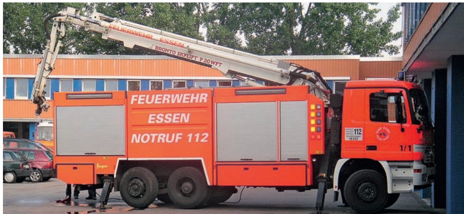
Abb. 3.6.7/1: GTLF mit Löscharm der Feuerwehr Essen auf MB Actros 2540 mit NALL (Nachlauflenkachse, vgl. CIMOLINO/ZAWADKE, 2005), Aufbau Ziegler. Das Fahrzeug entspricht bis auf die zusätzliche 750 kg BC-Pulveranlage (sv) und die FP 48/8 sowie dem Löscharm in der Beladung und den Löschmitteln einem TLF 24/50. (Beschafft u. a. von und für die Brandbekämpfung bei einer großen Firma.) (Foto: de Vries, Hamburg)
