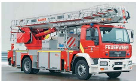
Abb. 3.7.4/1: Teleskopmastbühne mit angebauter Leiter (auch als TLK 23/12 oder ALP 320 bezeichnet) auf MAN LE 18.280 1 der Feuerwehr Alkoven. Der Korb ist so groß, dass auch Rollstuhlfahrer transportiert werden können. Neben einer Wasserleitung vom Drehstuhl zum Korb gibt es auch eine Atemluftversorgung nach oben. (Foto: Iveco Magirus, Ulm)
