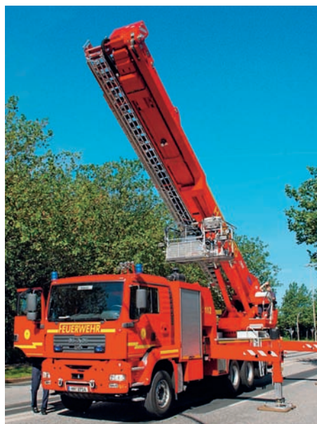
Abb. 3.7.4/5: Teleskopmastbühne von Bronto der Feuerwehr Hamburg auf MAN 26.413 FDLC+NLA. Gut ist die angebaute Leiter, der Korb mit der Zusatzausrüstung, der Gelenkarm im obersten Teil sowie die massive Abstützung zu sehen. (Foto: Lahmann, Hamburg)
