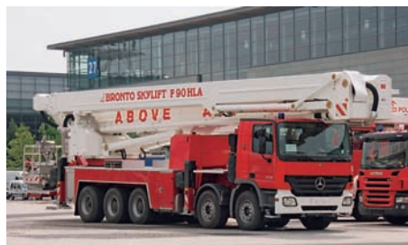
Abb. 3.7.4/4: Auf der Interschutz 2005 stellte Bronto eine TMB mit über 90 m Höhe vor, die im Verleihgeschäft eingesetzt werden soll. Als Fahrgestell wurde ein fünfschiger MB Actros 4150 verwendet. (Foto: Tampier, Dortmund)
