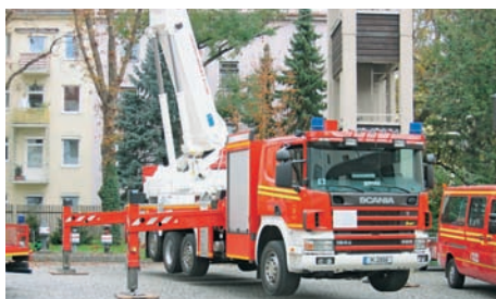
Abb. 3.7.4/2: Teleskopmastbühne Bronto Skylift F 53 RL mit 54 m Arbeitshöhe der Berufsfeuerwehr München auf einem Scaniachassis. Beachten Sie die Achsanordnung und die Fernfahrerkabine. (Foto: Zawadke, München)
