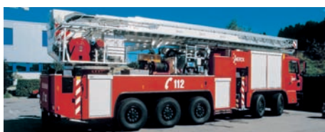
Abb. 3.7.4/3: Werkfeuerwehren nutzen teilweise noch größere Geräte, hier die 54-m-Teleskopmastbühne der WF Merck, Bronto TMB Typ HDT54 auf fünfschigem MAN-Chassis mit Allradlenkung und umfangreicher Löschtechnik sowie Zusatzausstattung (u. a. Cold Cut System). (Foto: Zawadke)
