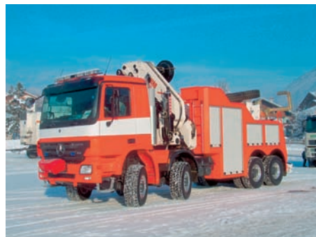
Abb. 3.11.1/13: Bergefahrzeug der Fa. Empl auf MB Actros. Beachten Sie die große Vorbauseilwinde, den schweren Ladekran und die Abschleppbrille. (Foto: Fa. Empl)
