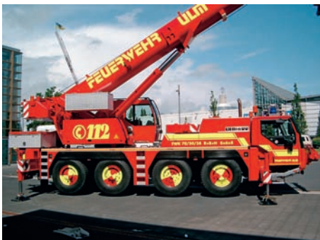
Abb. 3.11.1/12: Eine der letzten Feuerwehrlieferungen der Firma Liebherr vor Druck des Buches ist der LTM 1070-4.1 der Feuerwehr Ulm als FwK 70 mit 50 m Teleskopauslegerlänge. An der Spitze ist ein Monitor mit 5.000 l/min einsetzbar. Das Gesamtgewicht beträgt 48 t. (Foto: Zawadke)
