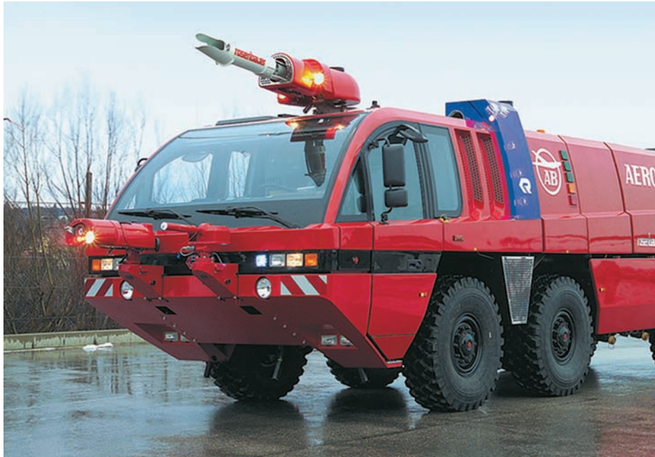
Abb. 3.13.7/4: Fahrzeuge mit dreifachem Löschmittelvorrat (Wasser, Schaum, Pulver) haben zusätzlich zum leistungsstarken Dachwerfer meist an der Front zwei verschiedene Werfer oder einen Kombinationswerfer für Wasser-/Schaum und Pulver 1 (Foto: Rosenbauer)
