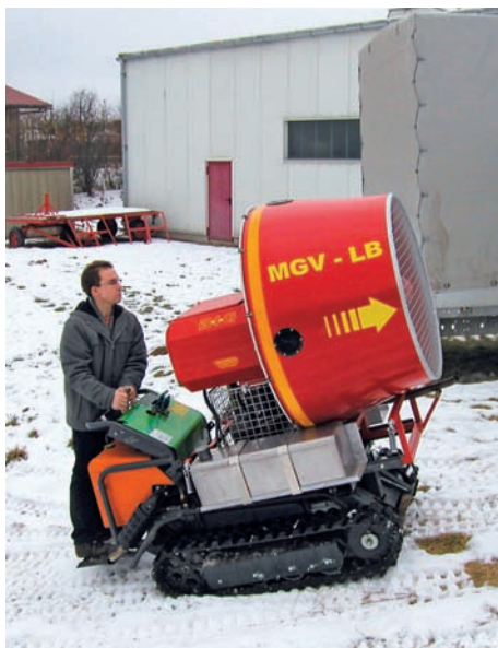
Abb. 3.14.1.4/3: MGV 2 (Fa. BIG) auf Kettenlaufwerk eines Dumperfahrzeuges, der auch in unwegsamem Gelände oder auf Bahndämmen eingesetzt werden kann. Eine Wasserzugabe ist möglich. Im Unterschied zum LUF 60 sind die Abmessungen, aber auch die Luftleistung größer. Bei Versuchen im Herbst 2005 war es mit zwei derartig dimensionierten Lüftern möglich, in einem Eisenbahntunnel mit stehendem Zug im Tunnel eine (allerdings relativ geringe) natürliche Luftströmung umzukehren. (Foto: Fischer, Stuttgart)
