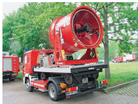
Abb. 3.14.1.4/4: Die FF Neuenstadt verfügt über LKW (MAN LW 8.140 C) mit einem dreh- und neig-, aber nicht ausfahrbaren MGV auf einer abnehmbaren (kranbaren 3 ) Plattform, die mit einer Schienenfahreinrichtung (Antrieb durch Luftstrom, mechanische Bremse) versehen ist. (Foto: Besemer, Offenau)
