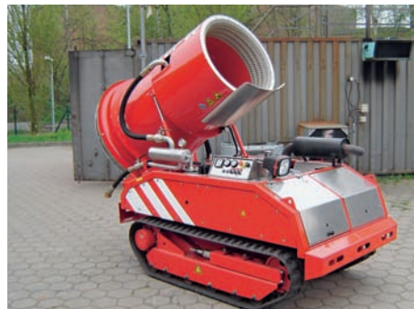
Abb. 3.14.1.4/2: Das LUF 60 der Rechner GmbH aus Österreich basiert auf einer Schneekanone und einem Minibagger-/dumper-Laufwerk 1 mit optimiertem Motor (arbeitet auch noch mit etwas niedrigeren Sauerstoffkonzentrationen). Die Zugabe von Wasser in den Luftstrahl ist möglich, ebenso die Vornahme eines „Schnellangriffsschlauchs“ vom LUF aus. Damit die Wasserabgabe funktioniert, müssen allerdings alternierend zwei B-Leitungen verlegt werden. Zum LUF gibt es mittlerweile eine Schienenfahreinrichtung (vgl. Abb. 3.14.1.5/7), womit das LUF auch über Bahnsteige z. B. in eine U-Bahn eingebracht werden kann. Der Motor funktioniert angeblich auch noch bei etwas „schlechterer“ Umgebungsluft. (Foto: Giese, Winsen-Luhe)
