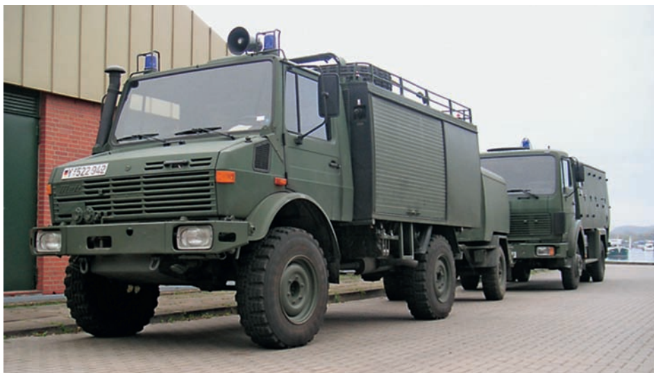
Abb. 3.14.1.7/3: Ungefähr dem TLF 8(W) entsprechendes TLF mit kleiner Pulverlöschanlage auf U 1300 mit TSA (geländegängige Ausführung) und MB 1017 AK (ungefähr TLF 16/25) der Bundeswehr mit löschtechnischer Beladung. (Foto: de Vries, Hamburg).
