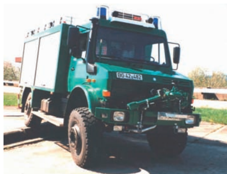
Abb. 3.14.1.7/2: TLF 8/15 mit Frontwerfer der Bundespolizei auf Unimog U 2450 (Foto: Giese, Winsen-Luhe)
