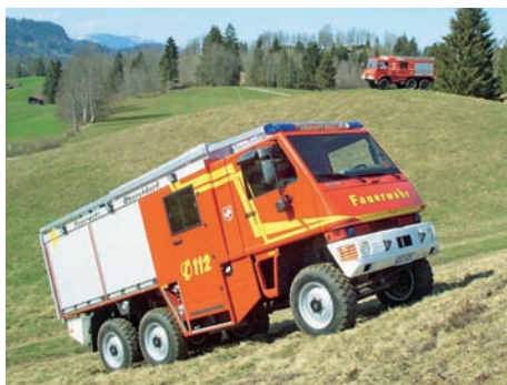
Abb. 3.14.1.7/1: HLF der Feuerwehr Oberstdorf. Fahrgestell Bucher Duro 6x6 mit ca. 8 t Gesamtmasse und 2 (!) m Breite. Aufbau der Fa. Brändle/CH. 1/7 Mann Besatzung, sechs PA in Kabine, FP ca. 600 l/min bei 7 bar hydraulisch betrieben, Tank 450 l, 23 kVA-Stromerzeuger fest eingebaut, zwei Rollcontainer im Heck (Foto: Vogler, Oberstdorf)
