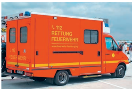
Abb. 4.3.2/2b): Koffer-RTW auf einem serienmäßigen Fahrgestell, MB Sprinter 413 CDI, Aufbau Fahrtec (Die Folgebeschaffung erfolgte dann auf MB Sprinter 416 CDI, Luftfederung, wieder Aufbau Fahrtec.) (Foto: Lahmann, Hamburg)
