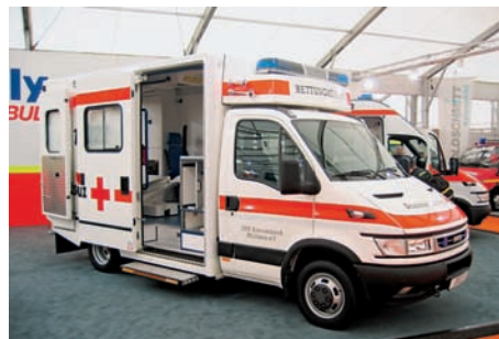
Abb. 4.3.2/2c): Koffer-RTW auf einem serienmäßigen Fahrgestell, Iveco Daily mit Aufbau von Fahrtec für das DRK Müllheim (Foto: Herbold, Bochum)
