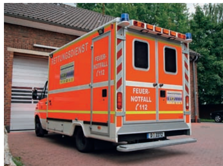
Abb. 4.3.2/2a): Koffer-RTW auf einem serienmäßigen Fahrgestell, MB Sprinter 416 CDI, Aufbau WAS, mit Luftfederung und voll-automatischen Getriebe 1 . (Foto: Truckenmüller, Düsseldorf)
