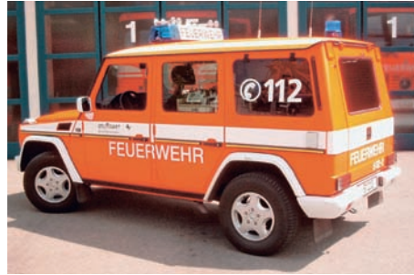
Abb. 4.3.3/2a): Das NEF auf MB G-Klasse der BF Stuttgart zeigt deutlich, dass selbst bei größeren Geländewagen immer noch neben der Hecktür zusätzliche Zugangsmöglichkeiten bzw. Stauräume geschaffen werden müssen, hier z. B. seitliche Heckscheiben, linke hintere Tür, um die umfangreiche Ausstattung unterbringen zu können. (Foto: Ossendorf, Stuttgart)
