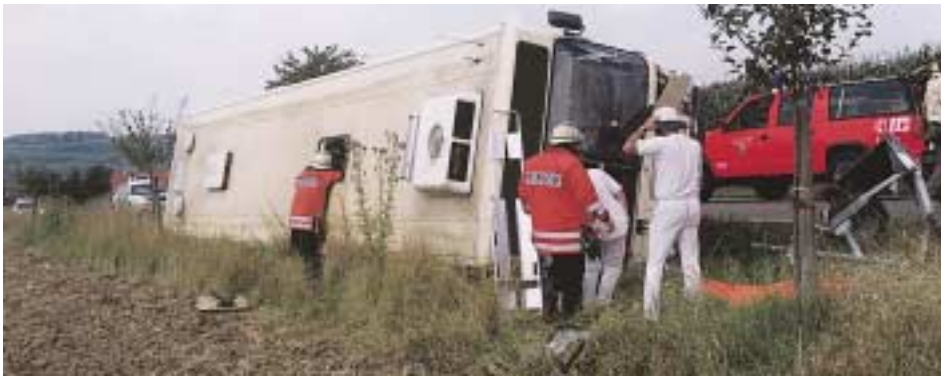
Abb. 2.5/1: Die ersten Einheiten sind eingetroffen. Abstützmaßnahmen sind zu diesem Zeitpunkt hier nicht erforderlich, da der Bus stabil auf einer Seite liegt. Ein Erstzugang durch den Notausstieg im Dach ist gerade geschaffen worden, der zweite wird durch die Frontscheibe gerade vorbereitet. (Foto: Rosar, Stuttgart)
