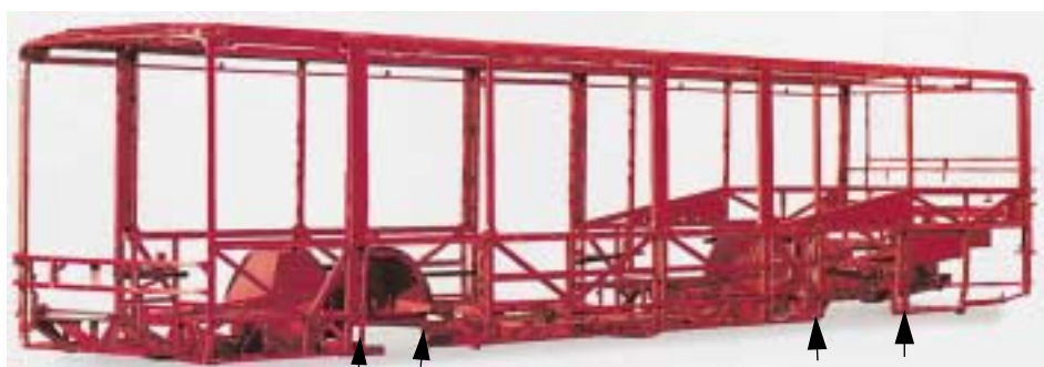
Abb. 3.6/1 b): Aufbau mit eingezeichneten Hebebohlen an einem Bus (Foto: Setra)
