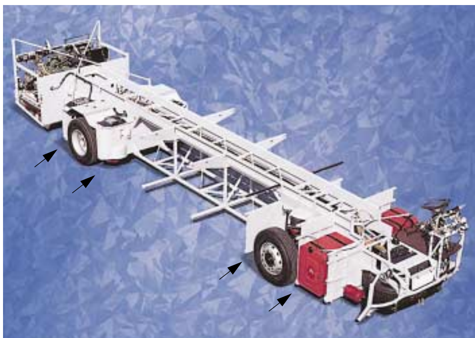
Abb. 3.6/1 a): Rahmen mit eingezeichneten Hebebohlen an einem Bus (Foto: Mercedes-Benz)
