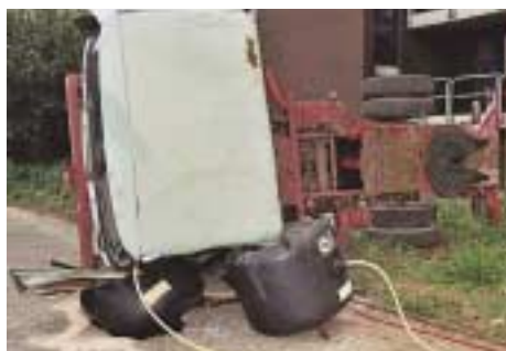
Abb. 4.3/5: Beide Kissen sind instabil, da das Fahrzeug nicht ausreichend gesichert wurde. Das linke Hebekissen wird durch die scharfen Kanten der Fahrertür gefährdet. (Foto: Trunittschek, Feuerwehr Düsseldorf)
