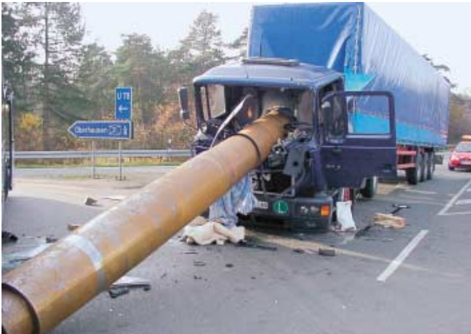
Abb. 3.3.2/14: Die Ladung (hier ein Stahlrohr) durchschlug beim Bremsen (!) die LKW-Kabine von hinten und traf einen Bus seitlich. Beachten Sie durch die Verlagerung die neue Gewichtsverteilung (Führerhaus sitzt vorn am Boden auf, Hinterachse ist in der Luft!)(Foto: Johann Ridder, www.ladungssicherungskreis.de )
