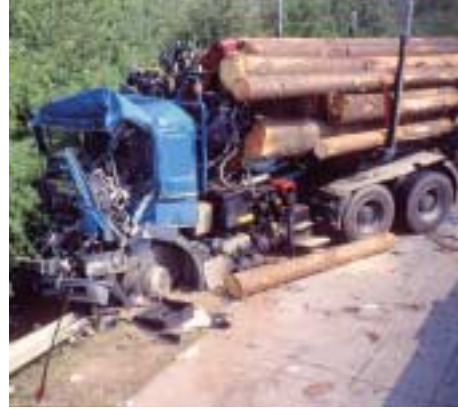
Abb. 3.3.2/13: Bei diesem Unfall mit einem Langholztransporter wurde die Fahrertür durch einen nach vorne geschobenen Baumstamm verriegelt. Dieser musste mit einer Motorkettensäge entfernt werden (Sägespäne und abgesägter Baumstamm sowie seitlich eingedrücktes Führerhaus (B-/C-Säule) sind zu erkennen). (Foto: Feuerwehr Gensingen).
