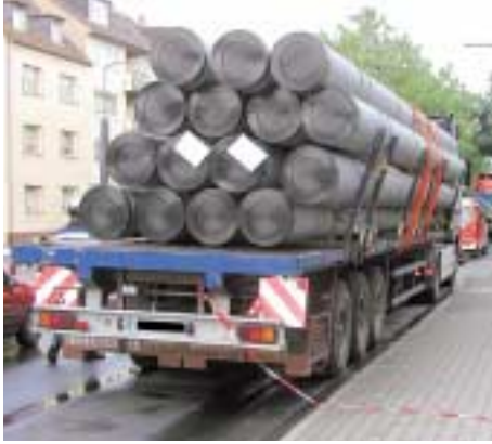
Abb. 3.3.2/12: Die Ladung ist durch mangelnde Ladungssicherung in instabilem Zustand. Vorsicht beim Öffnen der Verzurreinrichtungen von derartigen Transporten! (Foto: Bildstelle der Feuerwehr Düsseldorf)
