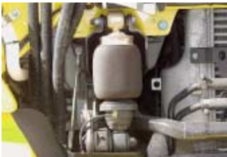
Abb. 3.3.5/8: Fahrerhauslagerung mit Luftfederung (Foto: Bohm, Ludwigshafen)
