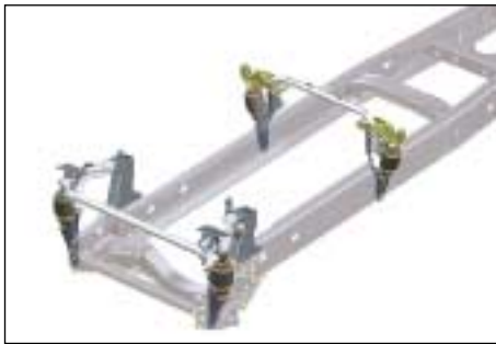
Abb. 3.3.5/6: Fahrerhauslagerung mit Crash-Elementen und Luftfederung (Grafik: MAN)
