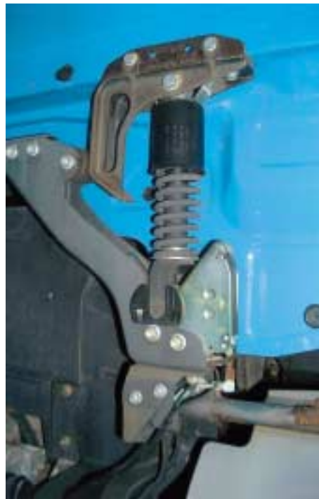
Abb. 3.3.5/7: Fahrerhauslagerung mit Spiralfederung (Foto: Bohm, Ludwigshafen)
