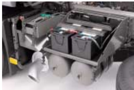
Abb. 3.3.7/1a) und b): Fahrzeugbatterie(n) mit und ohne Schutzabdeckung am Fahrzeugrahmen (Fotos: Volvo)
