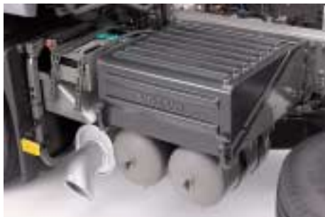
Abb. 3.3.7/1a) und b): Fahrzeugbatterie(n) mit und ohne Schutzabdeckung am Fahrzeugrahmen (Fotos: Volvo)
