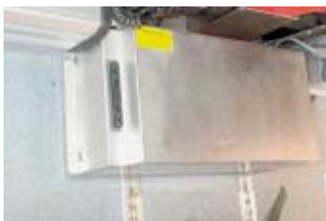
Abb. 3.3.7/4: Zusatz-(Gel-)Batterie in einem Notarztsatzfahrzeug (NEF) (Foto: Bildstelle der Feuerwehr Düsseldorf)
