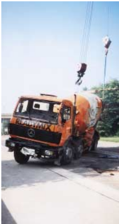
Abb. 4.10.2/2: Aufrichten eines Betonmischers mit Kran und Gegenzug (Foto: Bildstelle der Feuerwehr Düsseldorf)
