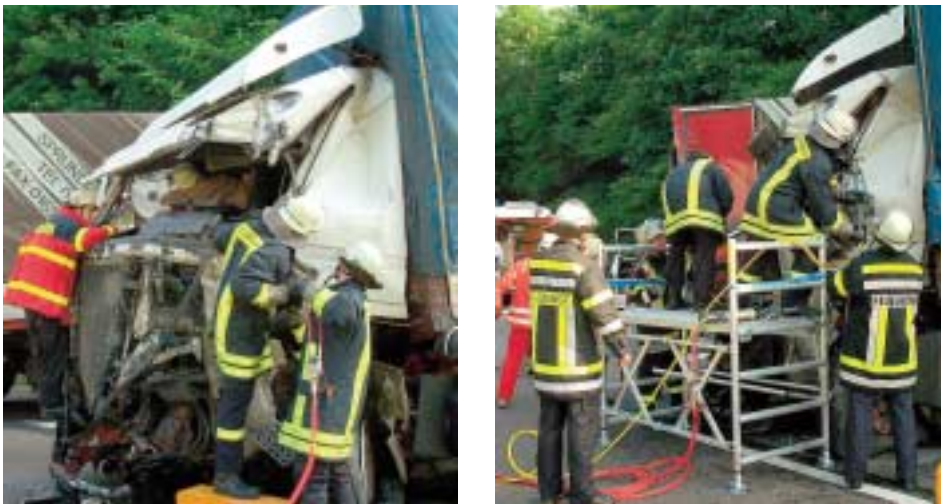
Abb. 4.13.2/1a) und b): Behelfsmöglichkeiten wie Kisten (s. Bildunterkante) bieten sehr kleine Stand- und Auflageflächen. Rettungs- bzw. Arbeitsplattformen bieten viel mehr Sicherheit und Arbeitsfläche als Kisten, Leitern o. ä. (Foto: Bildstelle der Feuerwehr Mönchengladbach)
