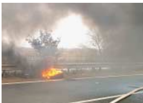
Abb. 6.7.2/5: Bei Kraftfahrzeugbränden bergen verschiedene Konstruktionsmerkmale (Airbags, Gasdruckdämpfer, Betriebsmittel) immer ein Risiko für Einsatzkräfte. Bei diesem Einsatz flog ein durch den Brand geplatzter Reifen quer über die Fahrbahn und wurde nur durch die Leitplanke gebremst. (Foto: Feuerwehr Schüttdorf)
