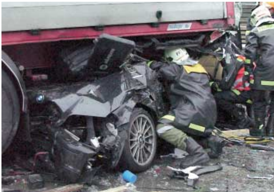
Abb. 2.3/1: Erkundung und Patientenbetreuung in einem verunfallten PKW unter einem bereits etwas angehobenen, aber noch nicht ausreichend gesicherten Auflieger (Foto: Kollinger)
