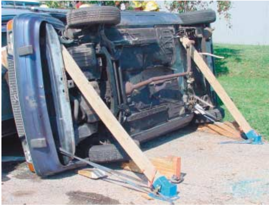
Abb. 4.6.6/2: Abstützsystem Fa. Zmag-Rescue (USA) (Foto: Dalrymple)
