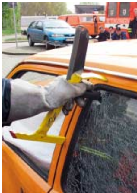
Abb. 4.8.3/4: Mit dem im Griff des GlasMaster integrierten Federkörner und den Anschlägen können Fensterscheiben sicher, ohne die Gefahr des „Hineindrückes“ angekörnt werden. (Foto: Südmersen)
