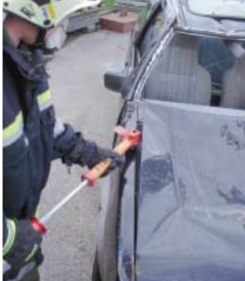
Abb. 6.7.5.4/2: Methode zum Öffnen der Motorhaube und des Kofferraums (Foto: Springer)
