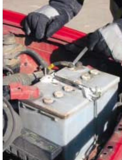
Abb. 6.7.5.4/3a): Abklemmen der Fahrzeugbatterie (Foto: Heck)
