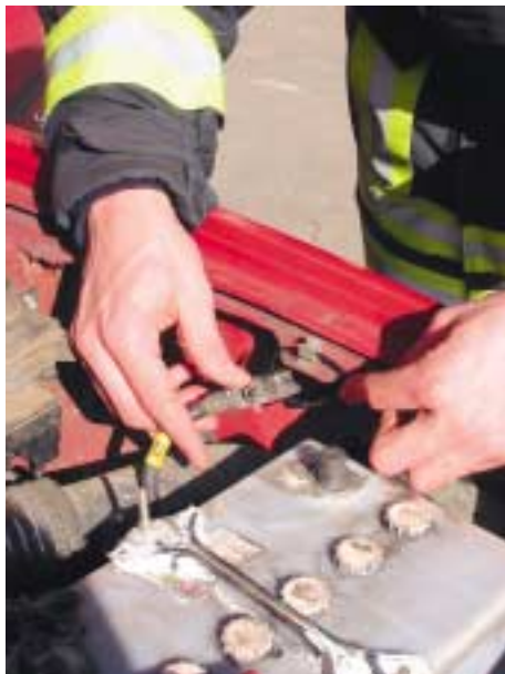
Abb. 6.7.5.4/3b): Abklemmen der Fahrzeugbatterie (Foto: Heck)
