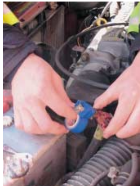
Abb. 6.7.5.4/4: Sicherung der freien Kabelenden (Foto: Heck)
