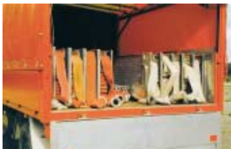
Abb. 4.2.4/2: Systematische Schlauchwagen-Beladung in Rohweiß und Rot (Foto: Weich)
