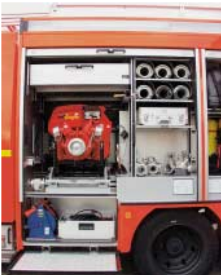
Abb. 4.4.3/9a) und b): Geräteraum G1 mit TS und Geräteraum GR mit Schlauchfächern eines Hamburger LF 16-TS (KatS) (Fotos: Plagens)
