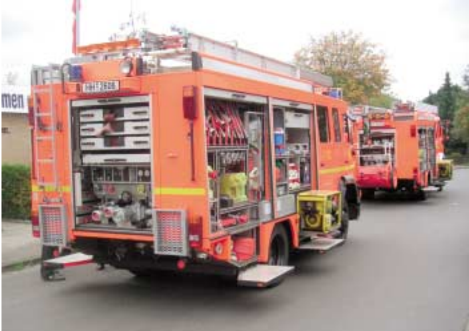
Abb. 4.4.3/8: Prototyp eines LF 16-TS (KatS), entwickelt von der Feuerwehr Hamburg (Fotos: Plagens)
