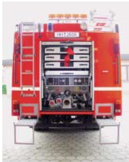
Abb. 4.4.3/9a) und b): Geräteraum G1 mit TS und Geräteraum GR mit Schlauchfächern eines Hamburger LF 16-TS (KatS) (Fotos: Plagens)
