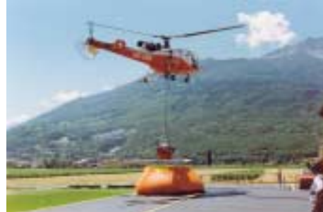
Abb. 4.6.1/1a) und b): Flexibler Außenlastbehälter der Fa. TELED im Heli, rechts befüllen am Wasserübergabepunkt (Fotos: Hartmann)
