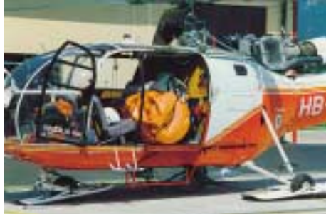
Abb. 4.6.1/1a) und b): Flexibler Außenlastbehälter der Fa. TELED im Heli, rechts befüllen am Wasserübergabepunkt (Fotos: Hartmann)
