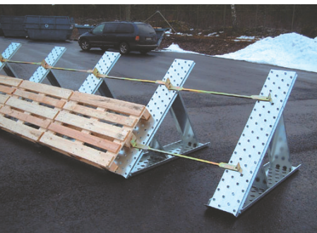
Abb. 3.1/8: Ansicht der teilweise montierten Schutzwand von vorne
