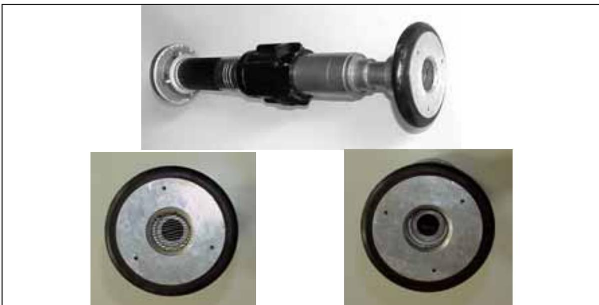
Abb. 3.2: Historisches deutsches B-Strahlrohr, Hersteller und Baujahr unbekannt (Bedienelement aus Bakelit)
