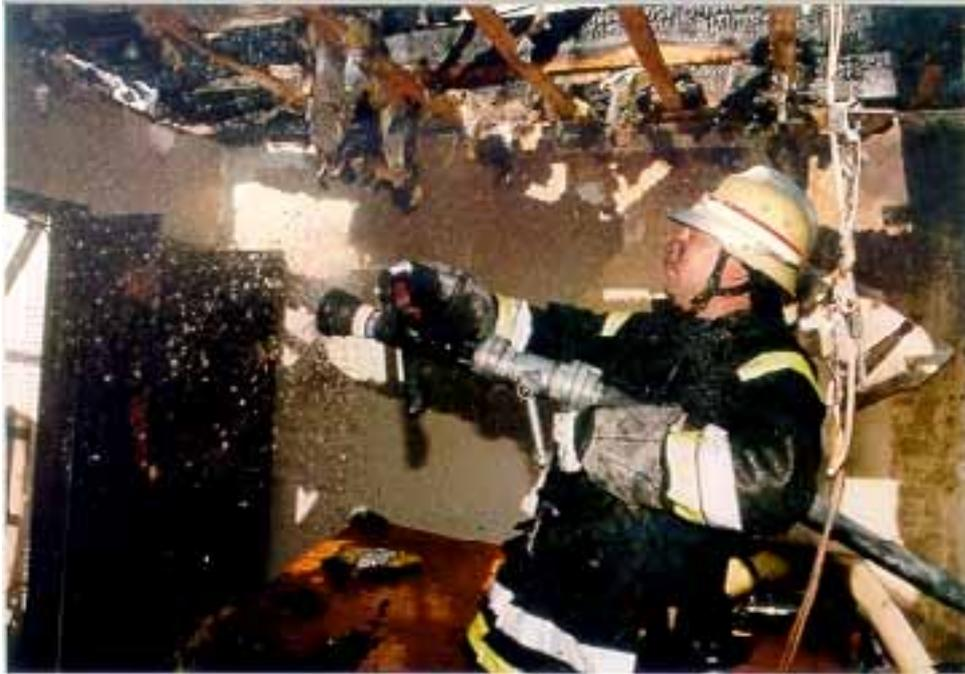
Abb. 3.7: "Automatik"-Strahlrohr TFT-BerlinForce, Durchfluß 100 – 400 l/min (Welcher Druck muß an der Pumpe gefahren werden, um bei halb aufgehaspeltem Schnellangriffschlauch am Stahlrohr noch 6 bar Druck und 400 l/min Durchfluß zu haben?) und Kugelhahn – zum Verlagern des Schnellangriffschlauchs durch C-Flachschlauch ... [68]
