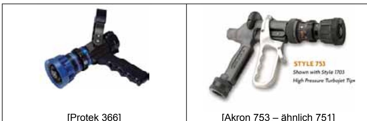
Das Arithmetische Mittel der Tropfengröße der Niederdruckstrahlrohre lag bei ca. 0,30 mm bei einem Durchfluß von 3,83 kg/s und 7 bar Strahlrohrdruck. Der Sauter-Durchmesser der Tropfen des Hochdruckstrahlrohres war 0,4873 mm, das Arithmetische Mittel betrug 0,2122 mm bei 6,9 bar und 2,73 kg/s [163,8 l/min].
