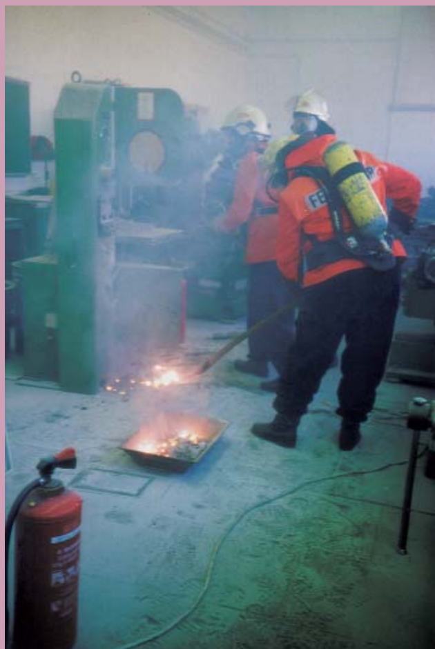
Bild 1 Die glühende Magnesiumspäne wurde in einer Schuttmulde gelagert und abgelöscht. [Foto: L. Kahla]
