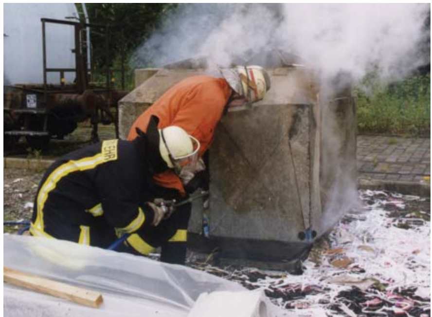
Bild 6 Brandversuch bei der Feuerwehr Bochum an Altpapiercontainern
