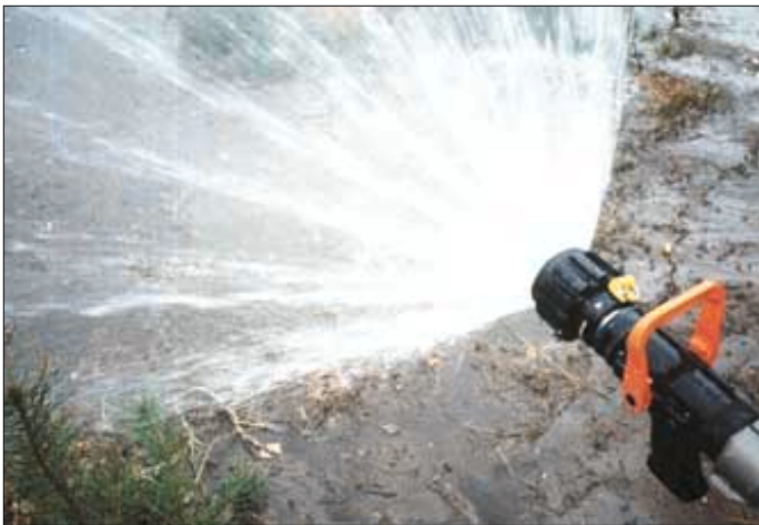
„Fingerbildung“: Bei Hohlstrahlrohren mit festen Zahnkränzen ist die Erscheinung ausgeprägter als bei solchen mit rotierenden Zahnkränzen.
